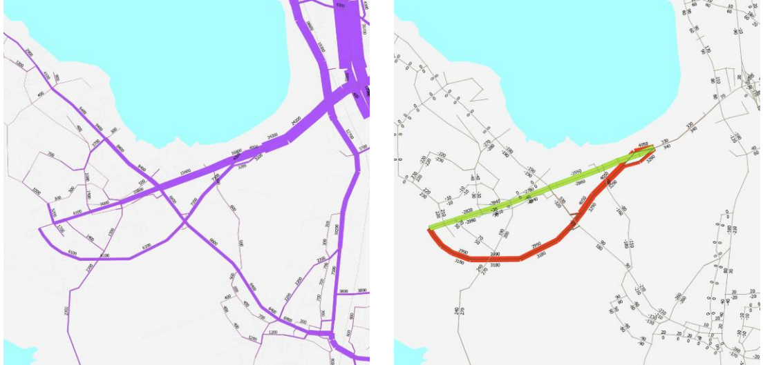
Kuva 4: Oulunsalon ohitustien (VE 1) liikenne-ennuste (KAVL 2030) ja liikenteen siirtymäkuva (vihreä= liikenne vähenee, punainen= liikenne lisääntyy).
